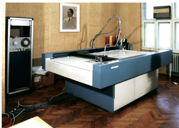
Плотер CALCOMP 7000, формат 2 X A0, тачност 0.1 мм
