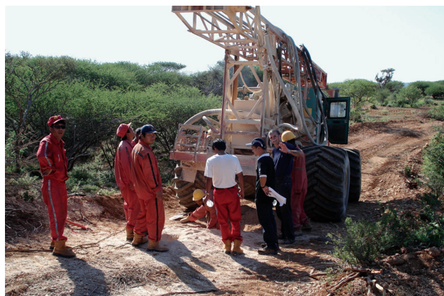
Слика 8. Гарнитура за бушење код извођења сеизмичких испитивања
