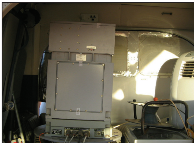
Слика 2. Гравиметар за мерење из ваздуха
