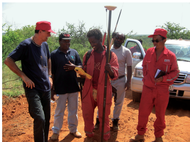
Слика 7. Коришћење GPS уређаја за трасирање сеизмичких профила
